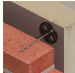
Gręžimo skylės matmenys: 8 mm x 50 iki 70 mm Vidinio sluoksnio įterpimo gylis: nuo 40 iki 60 mm
